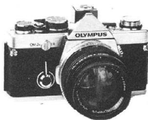
neringen med 1/70.000 sek. målereaktion. Øjeblikkelig korrektion af enhver lysændring, fra 1/1000 til 120 sekunder. TTL-styret blitzautomatik i forbindelse med Olympus T-serie flash, hvor selve OM-2 kameraet afbryder blitzglimtet nøjagtigt når filmen har fået lys nok, over alle objektivbrændvidder. Hele OM-systemet passer også til OM-2. Diodelampe i søgeren for flashberedskab og efterkontrol af flash-eksponering.
