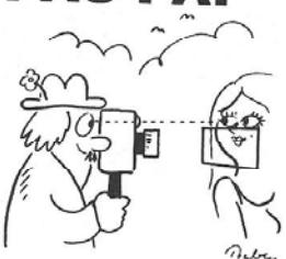
ved næroptagelse søgeren mod motivet fra en (mærkbart) anden vinkel end objektivet - p.gr. afstanden mellem søger og objektiv.
